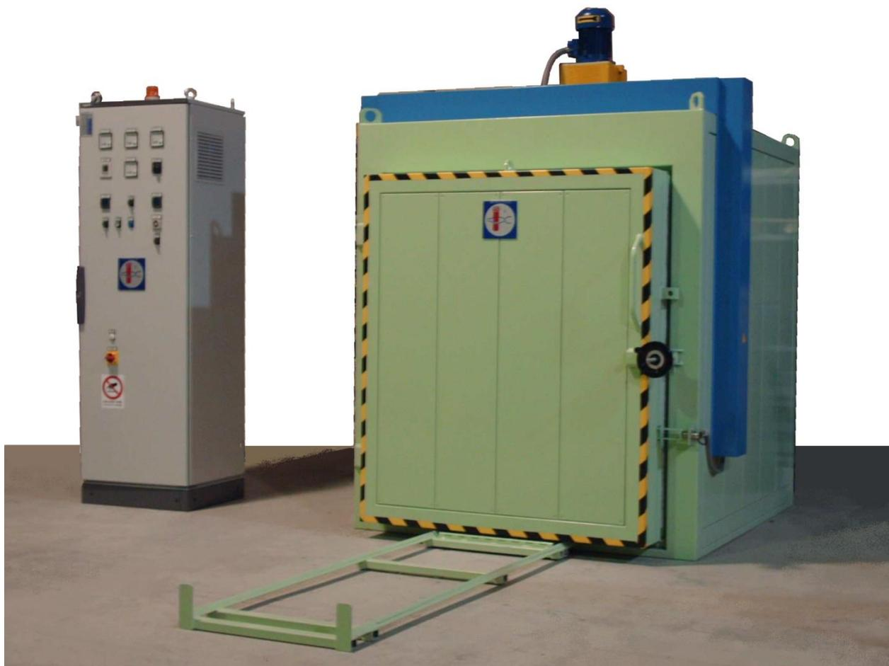
Тип: Электрическая, камерная печь, с выдвижным подом, с циркуляцией воздуха в комплекте с электроаппаратурой, расположенной в электрошкафу
